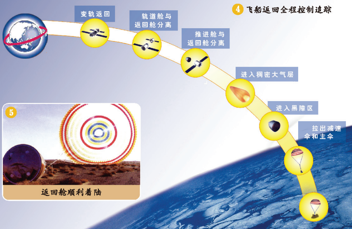
图4-7 神舟号载人飞船飞行控制全过程
