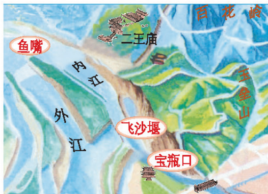
图3-1 都江堰水利工程系统原理示意图
