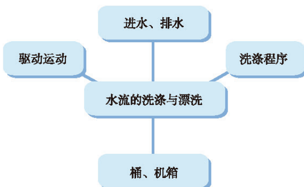
图3-15 洗衣机主要组成部分之间的关系示意图
