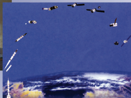
② 飞船经过入轨、定向、变轨等控制过程，最后进入圆形轨道飞行
