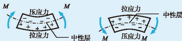
图1-29 梁的变形与应力表示
